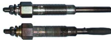
Bilde 26. Intakt glødeplugg (over) og glødeplugg skadet i kortslutning (under).
